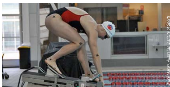
Le plot de départ (ici à l'Institut australien du sport, à Canberra) est équipé de capteurs de force. Des points sur le corps de l'athlète facilitent l'analyse biomécanique des enregistrements vidéo.
