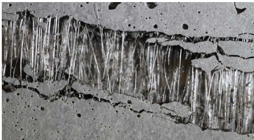
4. LE BÉTON FLEXIBLE ECC contient des fibres de polymère, qui établissent des ponts entre les bords des microfissures et empêchent ces dernières de trop s'élargir (à gauche; l'image couvre un champ de cinq millimètres). Les fibres, qui s'abrasent en glissant dans la matrice de ciment, sont de plus en plus liées à cette
