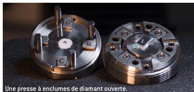
Une presse à enclumes de diamant ouverte.
