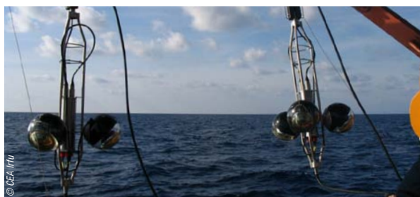
Les photomultiplicateurs d' Antarès en cours d'installation.
