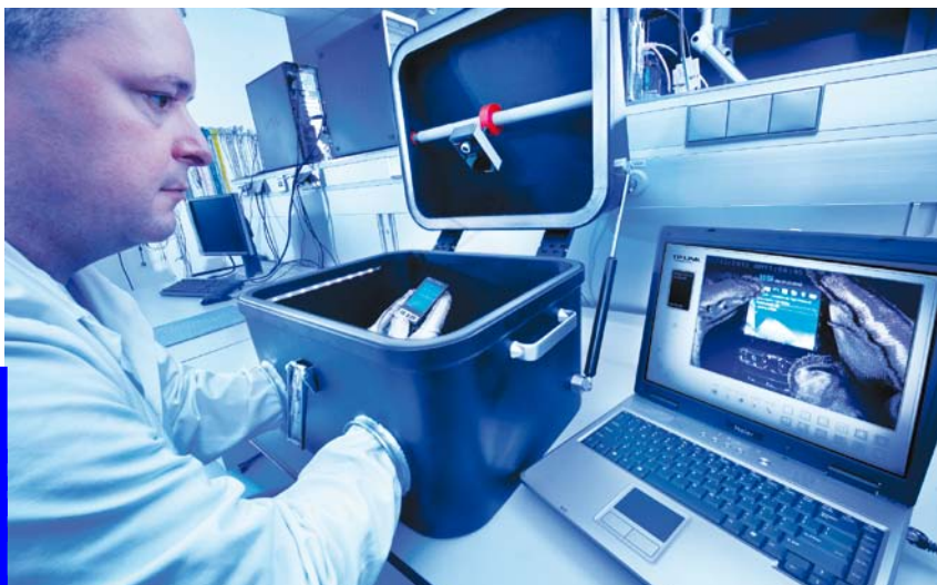
2. LES TELEPHONES PORTABLES sont placés dans une cage de Faraday, qui les isole des signaux radio. On minimise ainsi les risques de changement à distance de la mémoire. Celle-ci peut par exemple s'effacer automatiquement après réception d'un texto particulier. En temps normal, la boîte est fermée et l'analyste manipule le téléphone grâce à la caméra interne.
