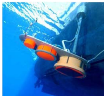
1. CE DISPOSITIF hydroacoustique est constitué de trois sondeurs émettant chacun à une fréquence spécifique (200, 120 et 38 kilohertz, de gauche à droite). Ils sont installés au plus près les uns des autres pour sonder le même volume d'eau.
