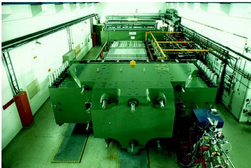
3. LES RÉCENTES EXPÉRIENCES DE DIFFUSION d'électrons ont été réalisées à l'Université Johannes Gutenberg de Mayence, en Allemagne, au moyen de l'accélérateur MAMI (Mainz Microtron). Cet accélérateur (ci-dessus, l'une des salles qu'il occupe) a fourni aux expérimentateurs des électrons d'énergie allant jusqu'à 855 mégaelectronvolts.
