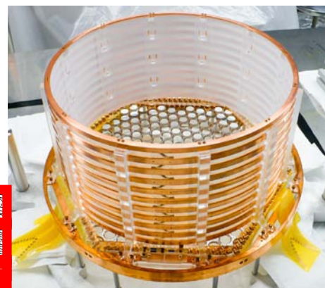
La cuve du détecteur EXO-200, qui traque les doubles désintégrations bêta sans émission de neutrinos.
