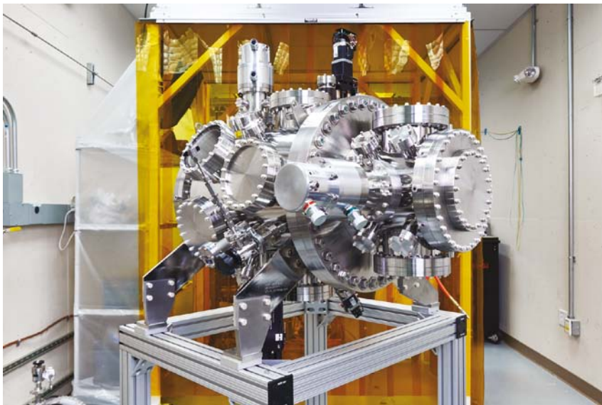
3. LES DETECTEURS PLACES DANS CETTE CHAMBRE A VIDE fournissent des images d'ultra-haute résolution de protéines et de cellules au moment où une impulsion X les éclaire
