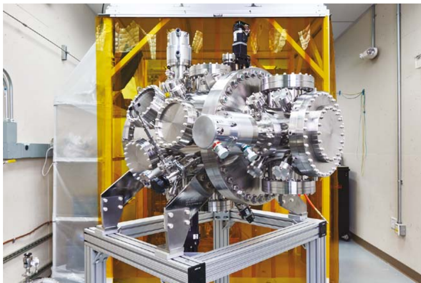
3. LES DÉTECTEURS PLACÉS DANS CETTE CHAMBRE À VIDE fournissent des images d'ultra haute résolution de protéines et de cellules au moment où une impulsion X les éclaire.
