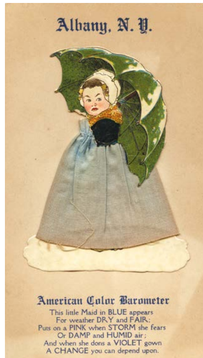
LE CHLORURE DE COBALT passe du bleu au rose quand il est mouillé. Cette réaction était utilisée au XIX e siècle dans des poupées dites (à tort) barométriques. Leur robe, bleue par temps sec, devenait rose quand l'humidité augmentait, indiquant un risque de pluie.
