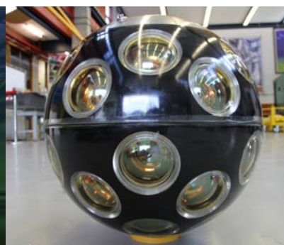
L'EAU PROFONDE de la Méditerranée est le milieu de détection des expériences ANTARES (à gauche) et KM3NeT . Celle-ci, en cours d'installation, sera équipée de modules optiques améliorés (à droite).
