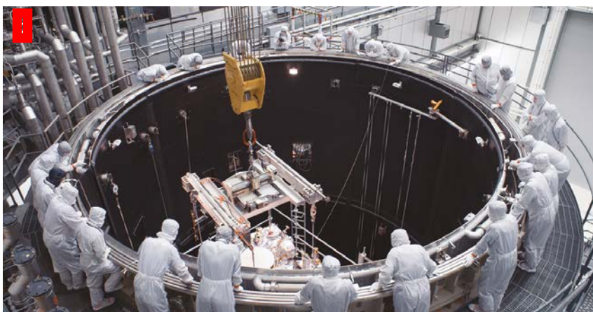
L'EPOQUE D'OSIRIS-REX a débuté douze ans avant son lancement en septembre 2016. La sonde a tout d'abord été assemblée (a), puis testée dans une chambre à vide (b) et dans des laboratoires d'acoustique (c) au sein du complexe Space Systems du Littleton, dans le Colorado, aux États-Unis.
