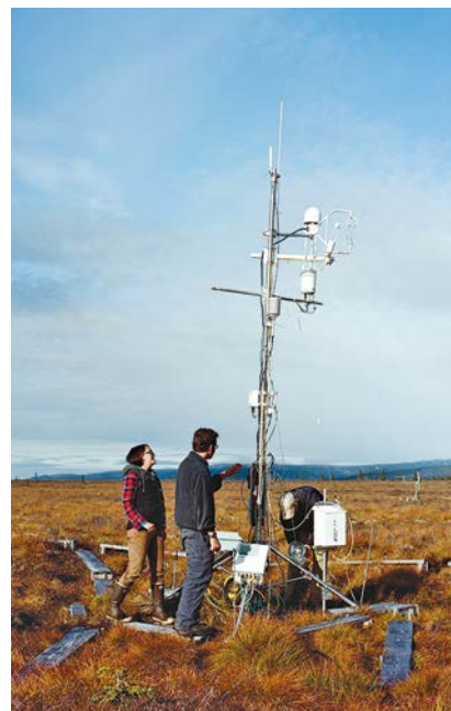
CETTE TOUR INSTRUMENTALE sert à mesurer, tout au long de l'année, les transferts de dioxyde de carbone et de méthane entre le sol et l'atmosphère. Elle permet de faire le bilan des émissions de gaz à effet de serre par l'écosystème de la toundra où elle est implantée.
