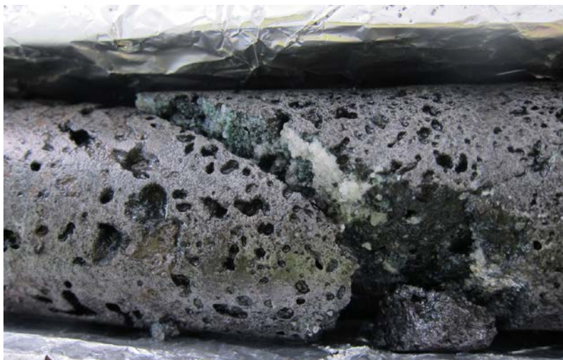
Prélevée sur le site d'injection du dioxyde de carbone dans l'aquifère basaltique islandais, cette carotte révèle la présence de minéraux carbonatés à l'intérieur de la roche.
