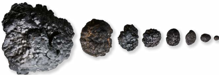
Quelques exemples de nodules polymétalliques rapportés de l'océan profond. Une telle concrétion contient typiquement 25% de son poids en manganèse et 3% en cobalt, en cuivre et en nickel.
