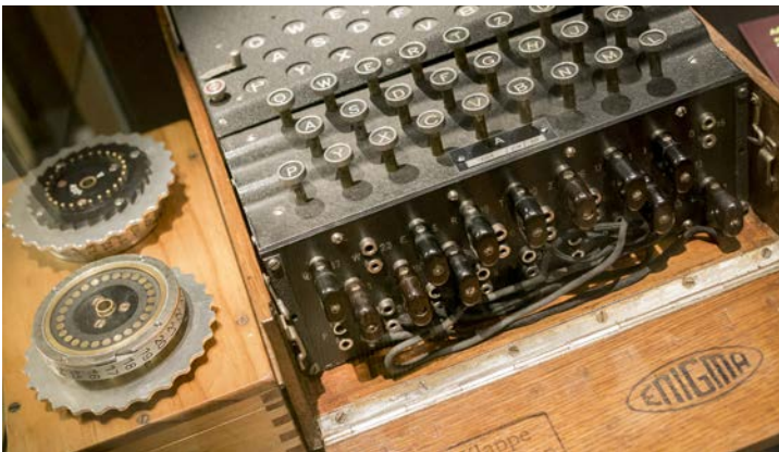
La machine Enigma, inventée dans les années 1920, était utilisée par l'armée allemande pour chiffrer ses messages.
