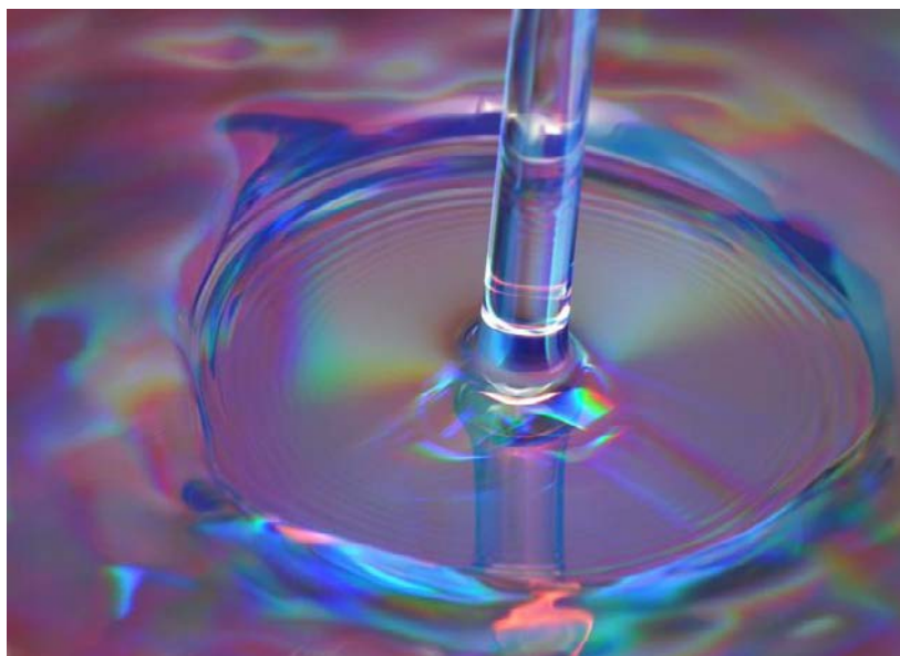
Dans l'évier, le jet d'eau forme une région très lisse cernée par un bourrelet turbulent. C'est le ressaut hydraulique.
