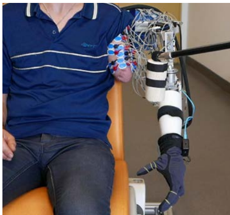
Grâce à un logiciel qui interprète les mouvements des muscles du moignon, le patient contrôle sa prothèse.
