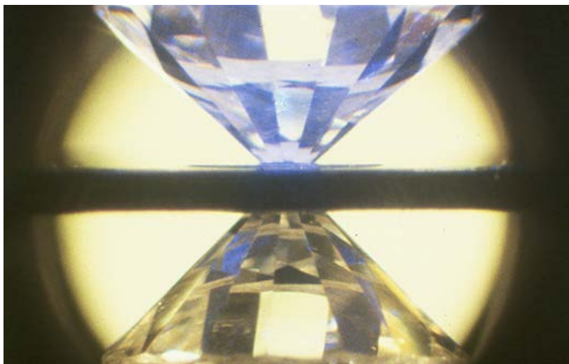
Une cellule à enclumes de diamant est capable d'exercer des pressions de plusieurs centaines de gigapascals (des millions de fois la pression atmosphérique).
