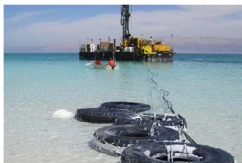
La plateforme scientifique utilisée pour extraire des sédiments à plusieurs centaines de mètres sous le fond de la mer Morte.
