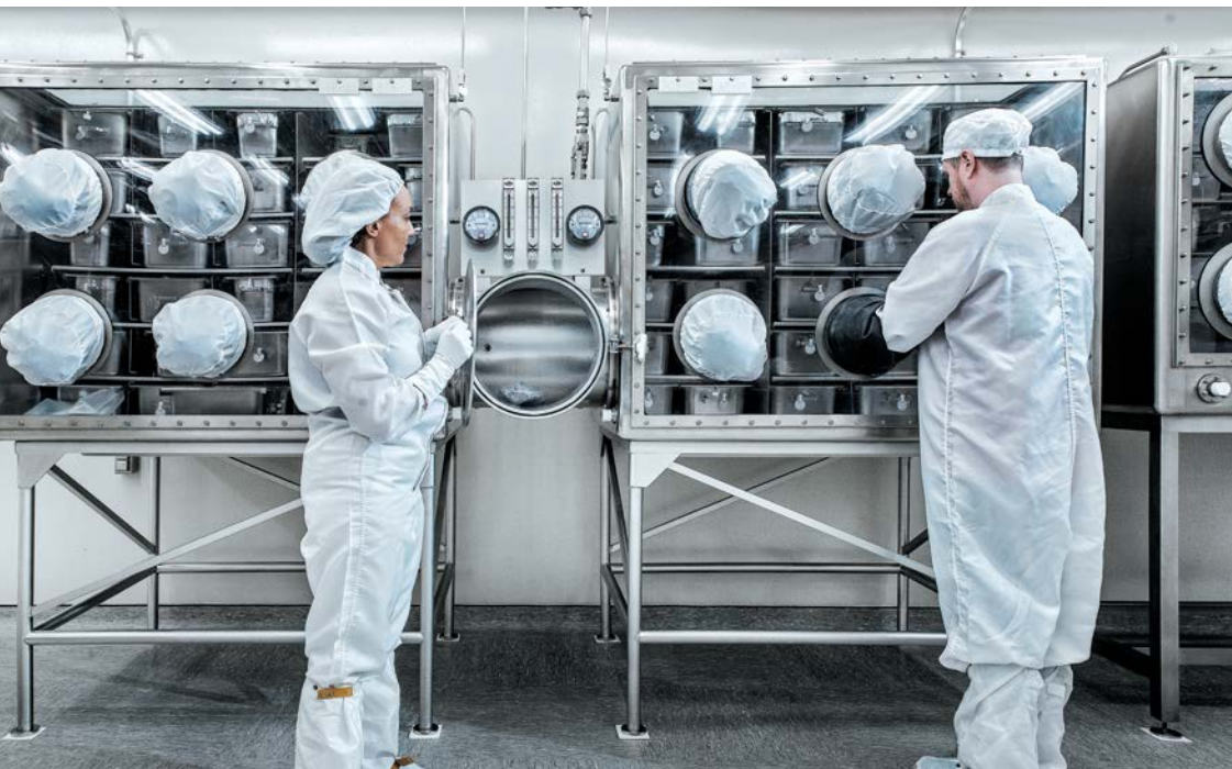
On voit ici un dispositif de conservation, en cours de manipulation pour déplacer un échantillon provenant de la mission Apollo 15 depuis son armoire de rangement sous azote vers un conteneur en acier inoxydable.
