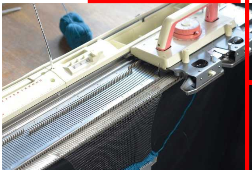
Avec cette machine à tricoter, l'auteur a produit des maillages très simples avec un fil de nylon.
