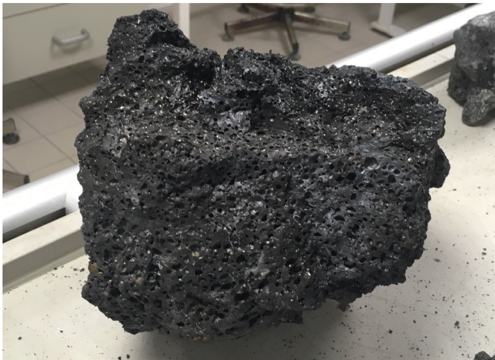
Ce fragment de lave solidifiée, remonté de quelque 3000 mètres de profondeur près de Mayotte, est une popping rock , c'est-à-dire une roche susceptible d'éclater parce qu'elle contient des bulles de gaz volcanique restées à la pression du fond (ici de l'ordre de 300 bars).
