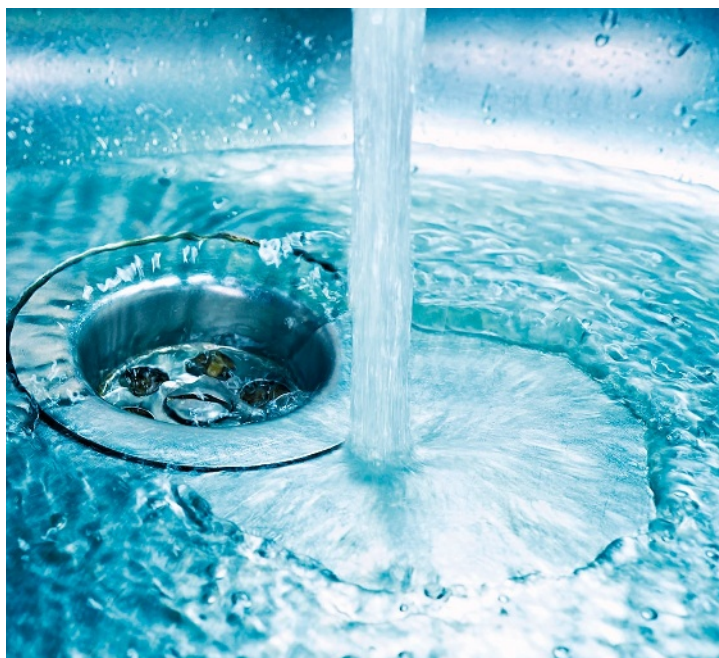
Ressaut hydraulique circulaire dans un évier. On observe une zone de faible épaisseur et de vitesse élevée près de l'impact, puis une zone de forte épaisseur et de faible vitesse après un «mur» liquide.
