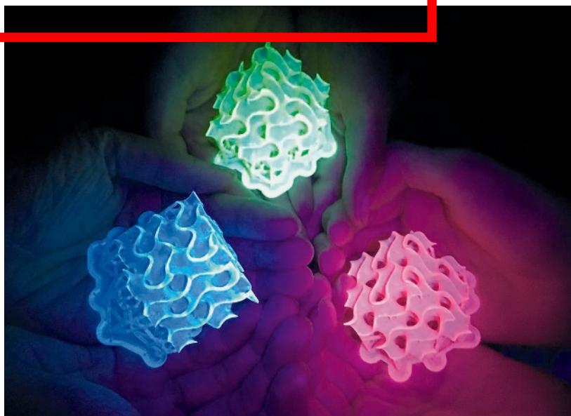
Dans le matériau solide, les molécules de cyanostar isolent spatialement et électroniquement les molécules fluorescentes les unes des autres. Il en résulte un solide très brillant.
