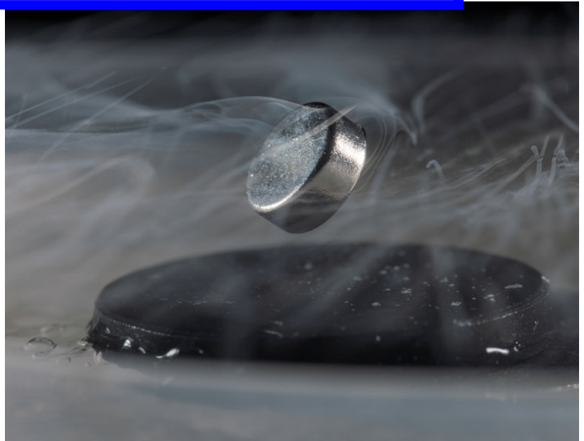
La supraconductivité est en général obtenue à des températures très basses. Elle permet de faire léviter des objets ou de faire circuler un courant électrique sans perte. À température ambiante, les applications seraient nombreuses.
