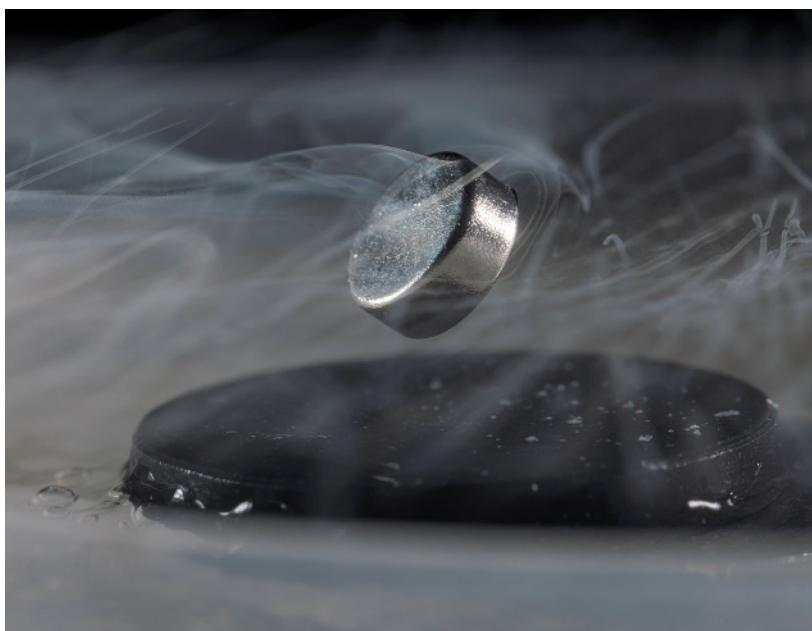
La supraconductivité est en général obtenue à des températures très basses. Elle permet de faire léviter des objets ou de faire circuler un courant électrique sans perte. À température ambiante, les applications seraient nombreuses.
