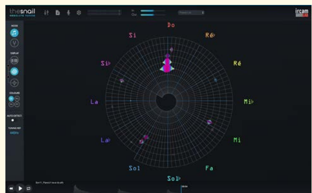
L'analyse par Snail du do central ( do 3) d'un piano droit (le point en cyan indique le diapason, ici, 440 Hz).
