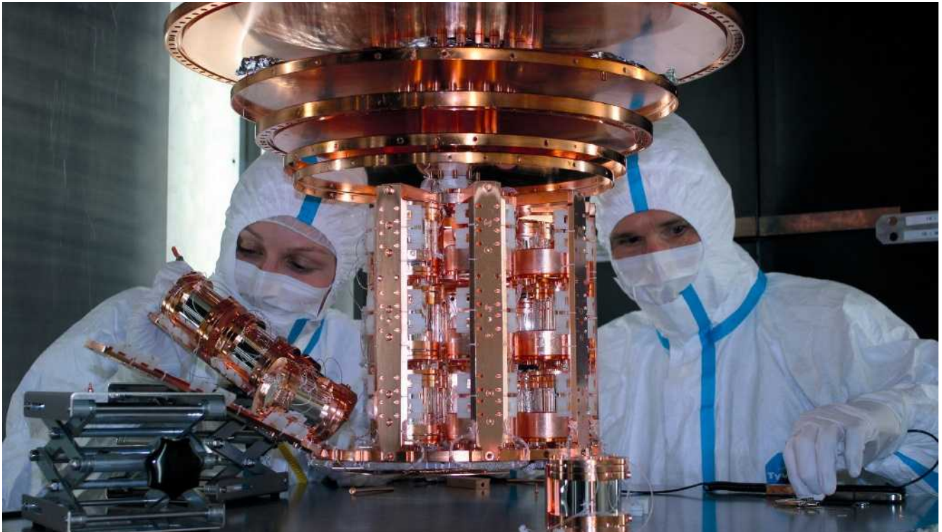
Le détecteur de l'expérience Cresst est enterré sous la chaîne des Apenins, en Italie, dans le laboratoire Gran Sasso. Il guette la matière noire, à l'abri des parasites de la radioactivité naturelle et des rayons cosmiques.
