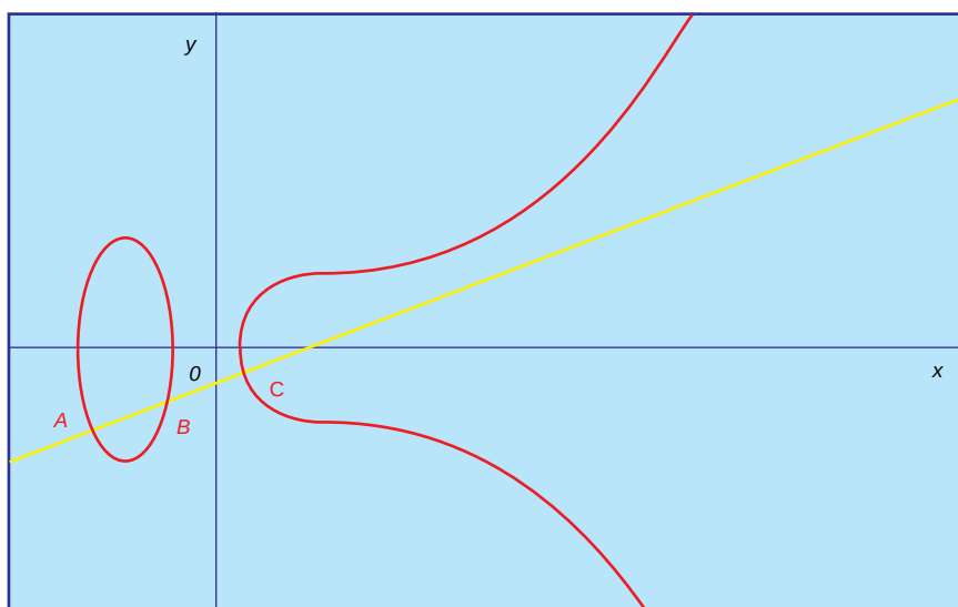
6. LA MÉTHODE DE LA CORDE, inventée par Newton, fut appliquée à la fin du siècle dernier à des courbes d'équation y^2 = P(x) , où P est un polynôme de degré égal à trois. Newton a remarqué qu'une droite qui passe par deux points de coordonnées rationnelles de la courbe passe également par un troisième point rationnel. La méthode de la tangente correspond au cas particulier où deux points sont confondus : la sécante devient une tangente, de sorte qu'un point rationnel en détermine un autre.
