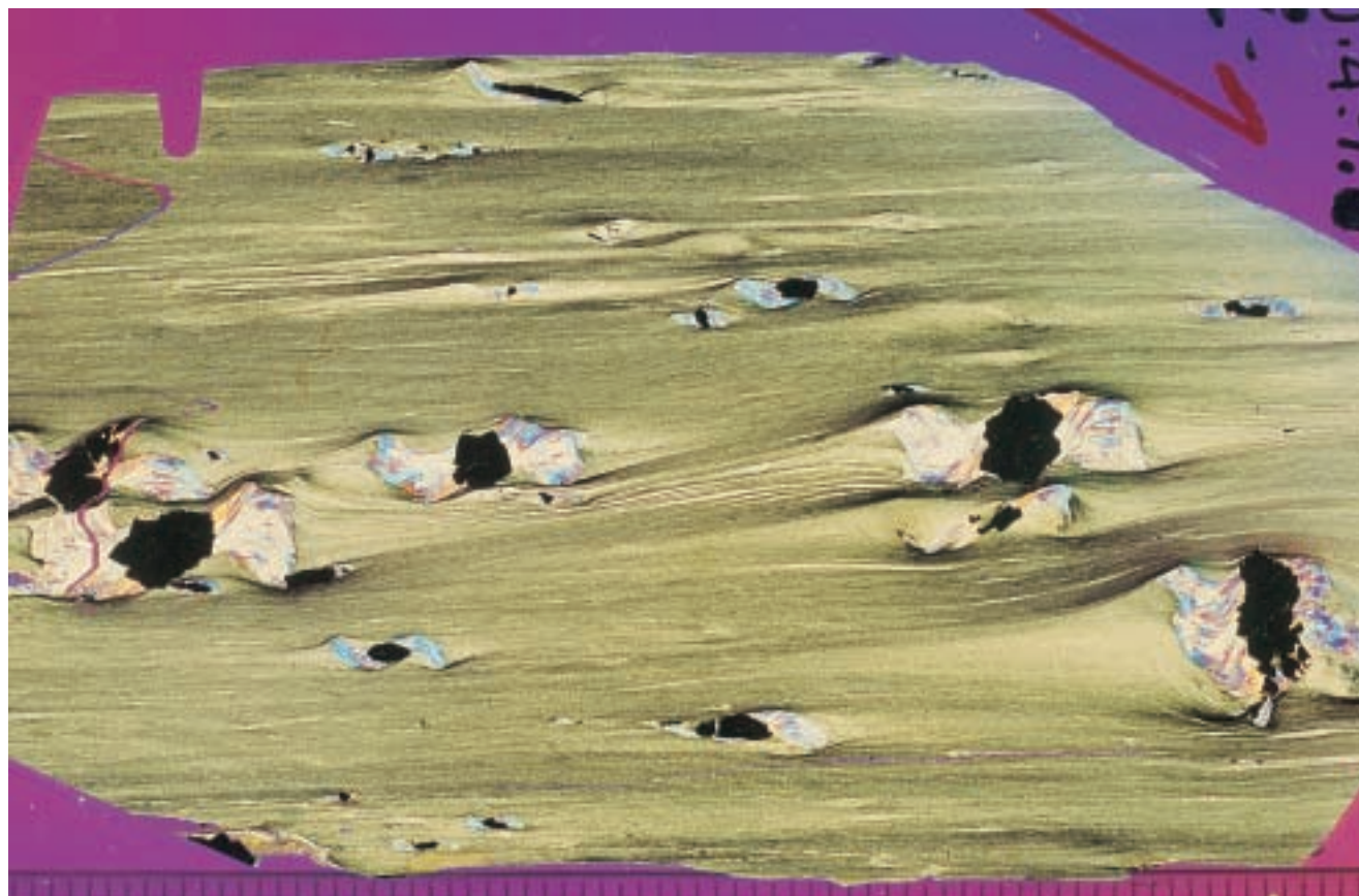
2. Lame mince d'une ardoise contenant des grains de pyrite entourés de cristallisations fibreuses (de quartz et calcite) qui soulignent l'étiement de la roche.
