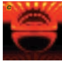
3. DES SIMULATIONS donnent un aperçu des possibilités de l'imagerie acoustique en son naturel. Ici on a calculé l'image que des systèmes complexes donneraient d'une sphère d'acier. On a supposé que le bruit ambiant proviendrait des vagues, représentées par des traits jaunes. Un système à 90 000 pixels donnerait une excellente résolution (a), mais il serait difficile à réaliser. Les images actuelles sont composées d'une centaine de pixels (b), mais on prévoit des systèmes qui formeront des images à 900 pixels (c).
