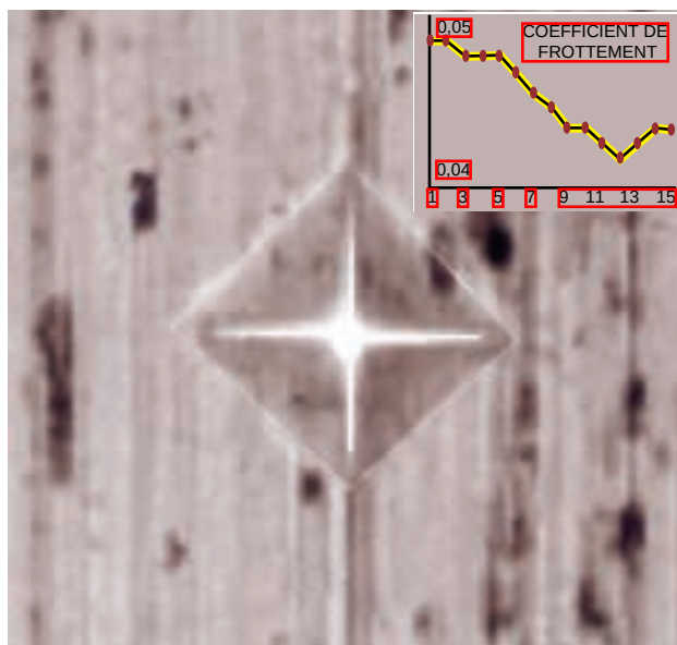
6. MICRO-INDENTATION pratiquée au centre d'une rayure d'un quasicristal icosaoédrique par un indenteur en carbure de tungstène fritté. La forme de l'indentation indique que le matériau rayé est ductile, alors qu'il était initialement fragile. En haut, variation du coefficient de frottement lors de passages successifs d'un indenteur diamant.
