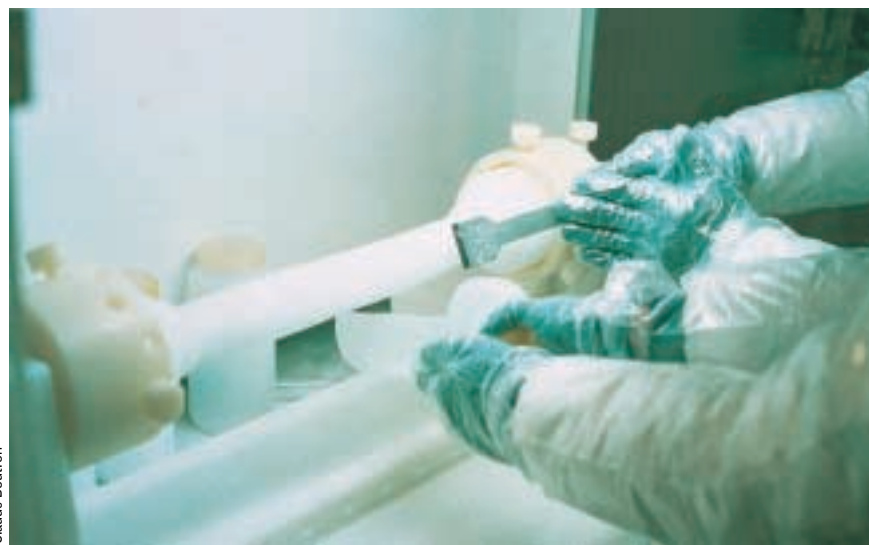
2. DÉCONTAMINATION d'une carotte de glace en chambre froide à l'intérieur d'une enceinte à flux laminaire d'air ultra-filtré. La carotte, maintenue horizontalement dans un tour entièrement construit en polyéthylène, est découpée à partir de son extérieur. Chaque couche annulaire est récupérée séparément pour analyse. On isole ainsi la partie centrale, généralement vierge de toute contamination.
