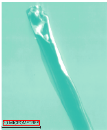
Deux des principaux sites de formation des bulles de champagne : les cristallisations (à gauche) et les fibres de cellulose laissées par les torchons, lors de l'essuyage (à droite).
