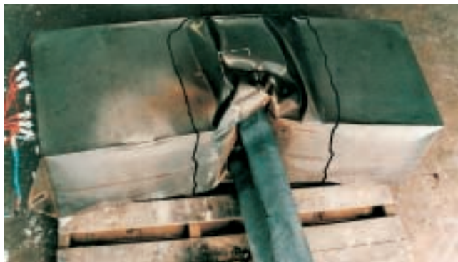
de l'environnement extérieur. Ce boîtier protège aussi contre d'éventuelles fuites lors de chocs violents, tel celui qu'a subi une batterie lors d'un essai de chute (à droite).
