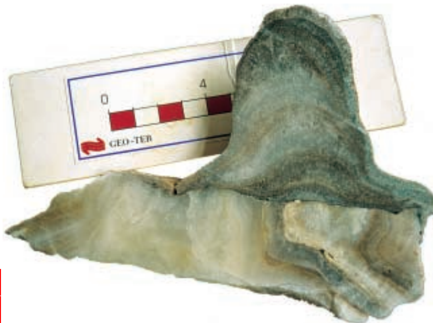
11. REPRISE DU CONCRETIONNEMENT sur le plan de cassure d'une stalagmite de la grotte de Rialb. La grotte est située dans la zone épiscopale du séisme de 1428 en Catalogne. Les géologues tentent de dater l'âge de la cassure.
