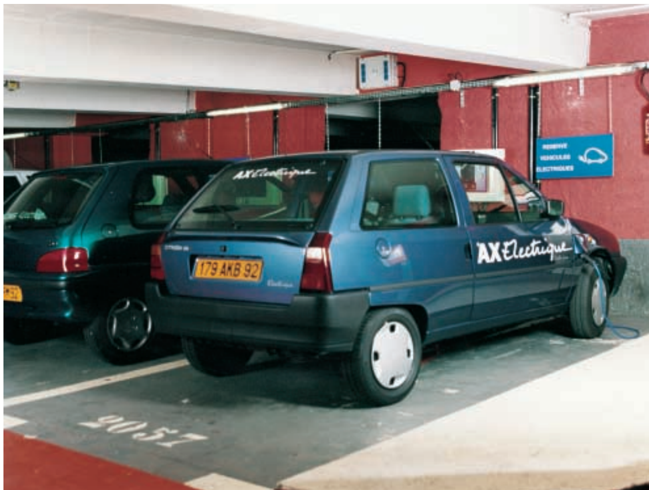
1. LES VEHICULES ÉLECTRIQUES, équipés de batteries, sont rechargés par un branchement électrique standard. Les utilisateurs profitent des arrêts, à domicile ou dans des parcs de stationnement, pour «faire le plein».
