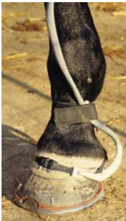
2. Ces capteurs fixés sur le pied d'un cheval mesurent l'accélération perçue par le pied.
