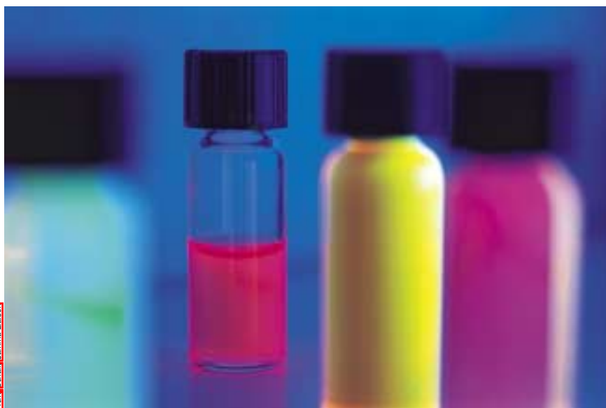
1. DES SUSPENSIONS DE PARTICULES NANOMETRIQUES du même matériau ont des couleurs différentes selon la taille de ces particules. Chacun des flacons présentés sur les photographies contient du sélénure de cadmium : seule la taille des grains varie. Chacun a une couleur différente, en lumière blanche (à droite) et en lumière ultraviolette (ci-dessus).
