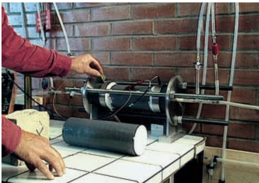
2. Echantillon de roche (cylindre) où l'on fait circuler de l'eau ; une différence de potentiel électrique apparaît entre les faces d'entrée et de sortie de l'eau.
