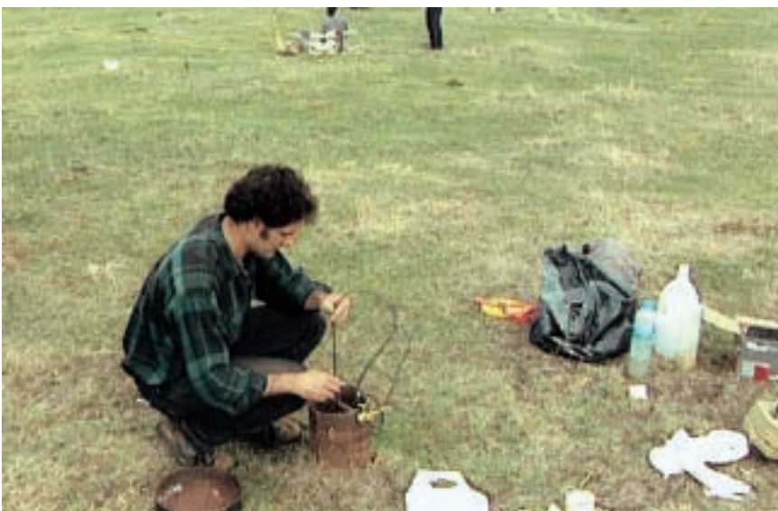
3. Descente d'une électrode dans un des puits de Mayet-de-Montagne.
