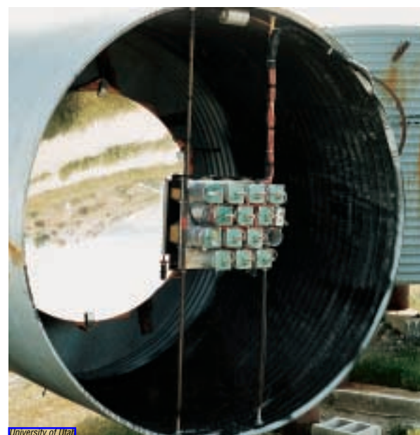
d'azote de l'atmosphère. A partir de ces données, on détermine l'énergie et l'identité probable des rayons cosmiques incidents. Le réseau Fly's Eye se trouve dans le désert de l'Utah ; une nouvelle version de ce réseau couvrira 1 000 kilomètres carrés.
