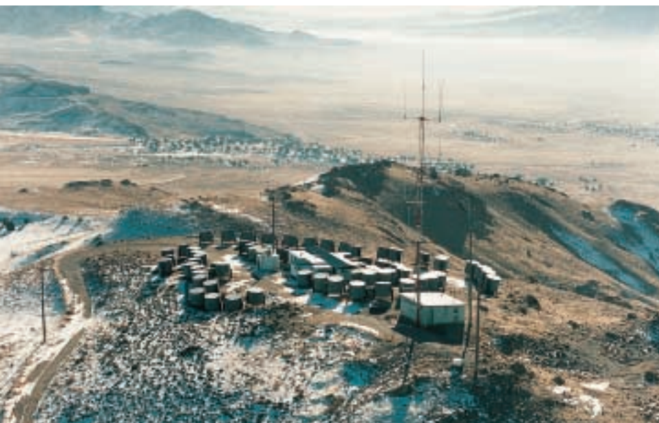
2. CE RESEAU DE DETECTEURS DE GERBES ATMOSPHERIQUES épie les sous-produits des rayons cosmiques qui pénètrent la haute atmosphère. Les photodétecteurs (à droite) enregistrent les éclairs lumineux provoqués par les rayons cosmiques qui heurtent les atomes
