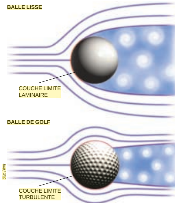
3. LA TRAÎNÉE D'UNE BALLE DE GOLF est principalement due à la pression de l'air. Cette traînée apparaît lorsque la pression devant la balle est bien supérieure à la pression derrière elle. On réduit la traînée en bosselant la surface de la balle ; les bosses et les creux accroissent la turbulence très près de la surface, ce qui entraîne un resserrement de la zone centrale du flux d'air, et donc une augmentation de la pression à l'arrière de la balle. Le diagramme ci-dessus montre que, pour des nombres de Reynolds accessibles lorsqu'on frappe la balle avec un club, la traînée est bien inférieure si la balle est bosselée.
