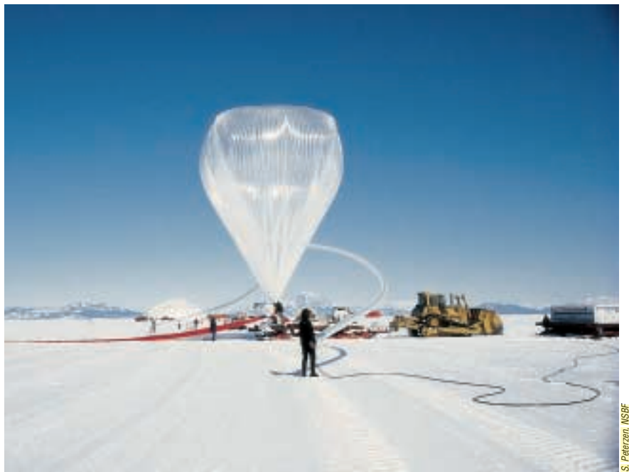
3. CE BALLON STRATOSPHERIQUE , lancé près de la base McMurdo, dans l'Antarctique, emporte un détecteur qui détectera directement les rayons cosmiques avant qu'ils ne créent des particules par collisions avec les atomes de l'atmosphère. À 40 kilomètres au-dessus de la calotte
