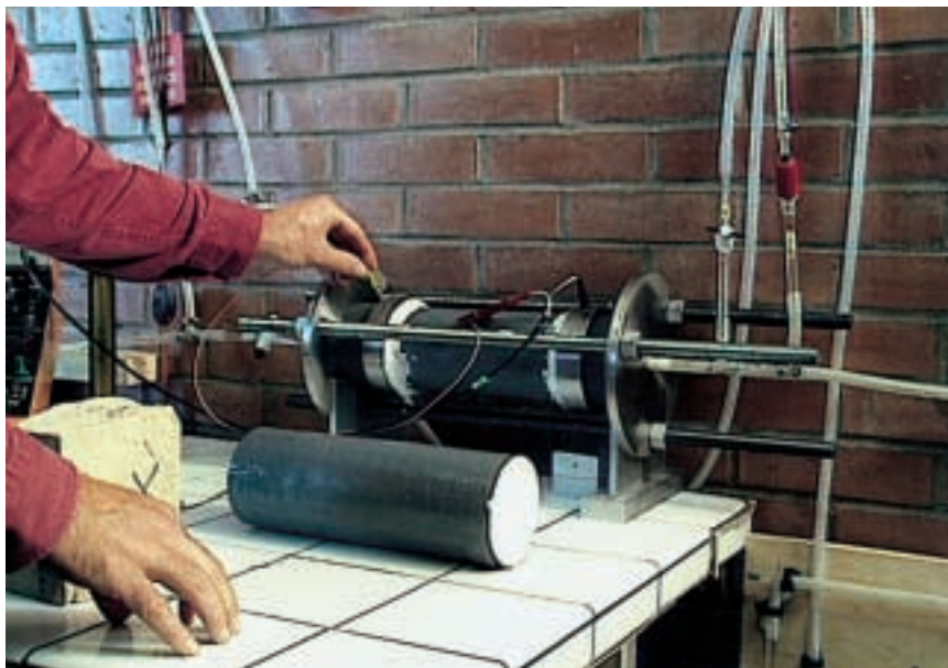
2. Échantillon de roche (cylindre) où l'on fait circuler de l'eau ; une différence de potentiel électrique apparaît entre les faces d'entrée et de sortie de l'eau.
