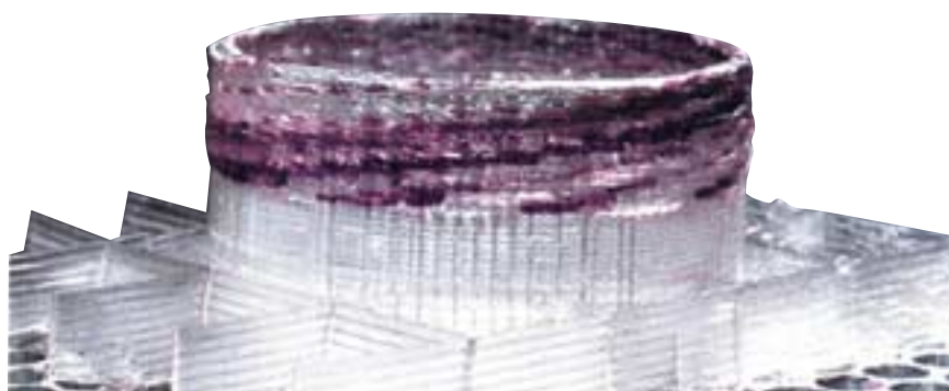
On fabrique des prototypes par tranches successives en polymérisant de petits volumes de monomère liquide à l'aide d'un laser ultraviolet. En déplaçant l'objet entre plusieurs bacs contenant le monomère teinté en différentes couleurs, on obtient des prototypes polychromes.
