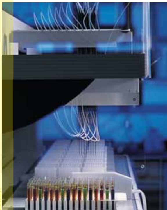
1. LE MÉLANGE aléatoire de sous-unités moléculaires est le fondement de la chimie combinatoire. Cette méthode permet de synthétiser rapidement d'innombrables molécules. Un robot (ci-dessus) répartit dans des tubes à essai (ci-dessus et à droite) les sous-unités qui réagissent pour former une grande variété de molécules.
