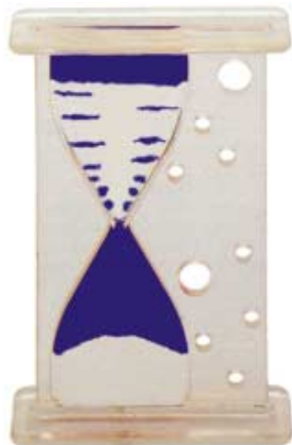
4. Quand on fait vibrer verticalement le sablier inversé, on observe la montée de «gouttes» de matière granulaire, qui se déforment en strates horizontales.
