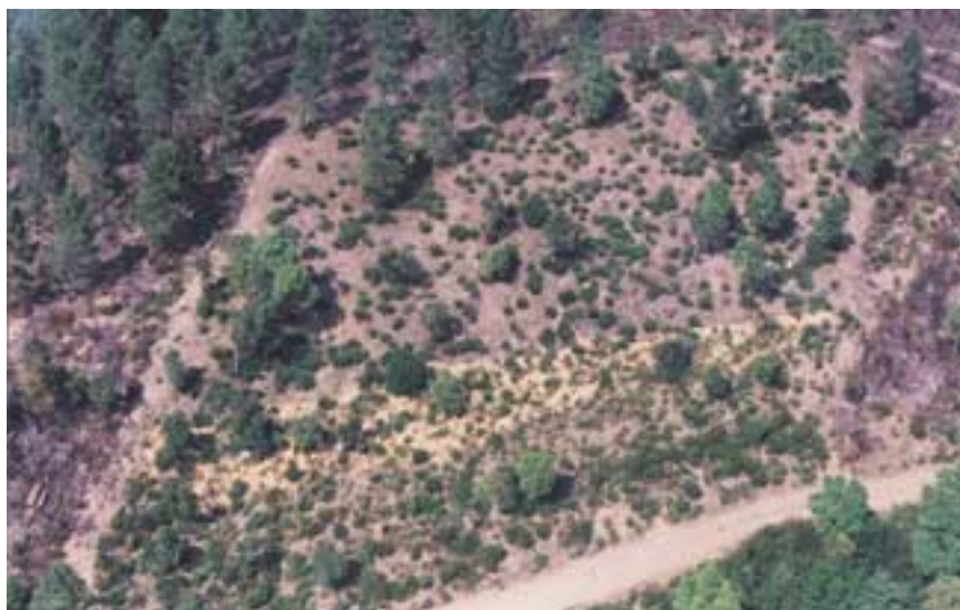
Vue aérienne d'un site d'expérimentation avant la mise à feu. Des broussailles ont été coupées pour ramener la densité de végétation sous le seuil critique. La ligne de mise à feu est au premier plan, recouverte de paille. Avec cette densité, le feu ne traverse pas le milieu aléatoire.
