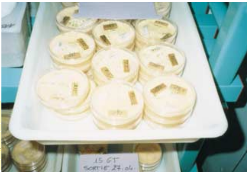
Pour tester la résistance de bois traités, on inocule des échantillons avec des pourritures et on les conserve dans des conditions constantes de température et d'hygrométrie.
