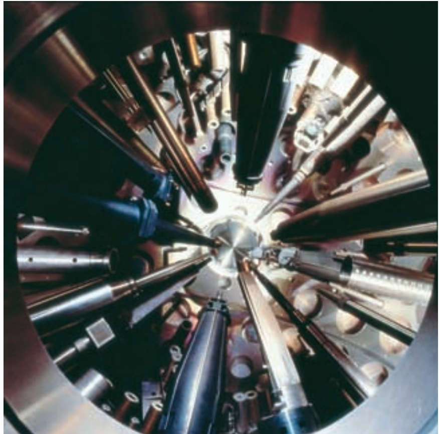
5. LA CHAMBRE D'EXPERIENCES du système Phébus , vu par dessous, à l'intérieur. Le disque central est le fond du système de descente de la cible. Les tubes qui convergent vers le point où la cible est descendue sont des systèmes de mesures : appareils photographiques à sténopé (où l'optique est réduite à un trou), spectrophotomètres, capteurs pour les mesures de température, de pression et d'énergie...
