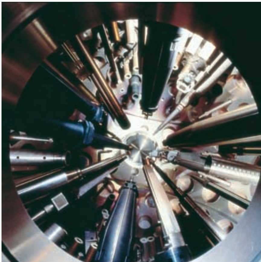
5. LA CHAMBRE D'EXPÉRIENCES du système Phébus , vu par dessous, à l'intérieur. Le disque central est le fond du système de descente de la cible. Les tubes qui convergent vers le point où la cible est descendue sont des systèmes de mesures : appareils photographiques à sténopé (où l'optique est réduite à un trou), spectrophotomètres, capteurs pour les mesures de température, de pression et d'énergie...
