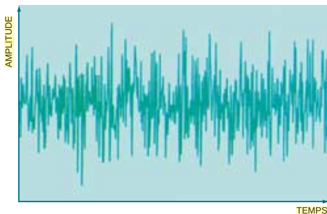
2. BRUIT BLANC gaussien (amplitude du signal en fonction du temps). Pour obtenir cette représentation, on a échantillonné 500 fois un processus qui engendre un bruit blanc : la caractéristique principale de ce type de bruit est qu'il ne possède pas de mémoire, dans le sens
